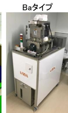
\*メーカー想定 of 最大値を使用。投入した紙オムツの大きさによって水量を調整する機能を備えているが、実証では、1枚投入の際のサイズの誤検知により、2枚分の水量が使用されるケースがあり、平均17L/回であった。
