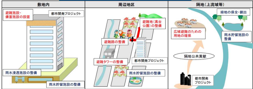
評価対象となる都市の水災害対策に資する取組のイメージ
