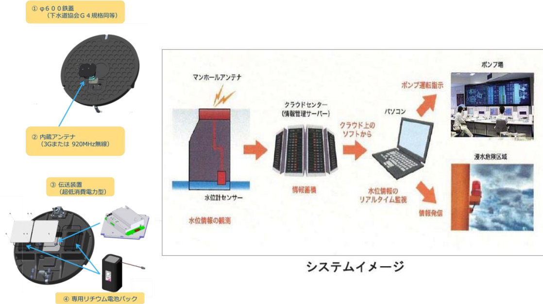
図 2-14 ICTを活用した水位等観測(マンホールアンテナ(水位計))
