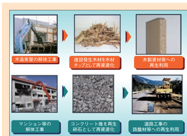
図表Ⅱ-7-2-2 建設リサイクルの取組み事例
