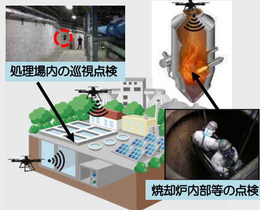
ドローンによる処理場内の点検
