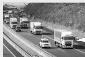
平成31年1月に後続車無人システム(後続車有人状態)の公道実証実験を実施
