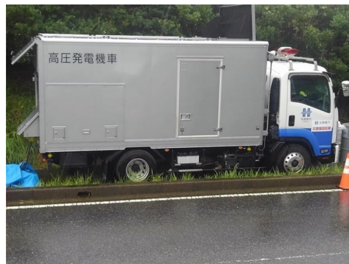
電源車の配備
