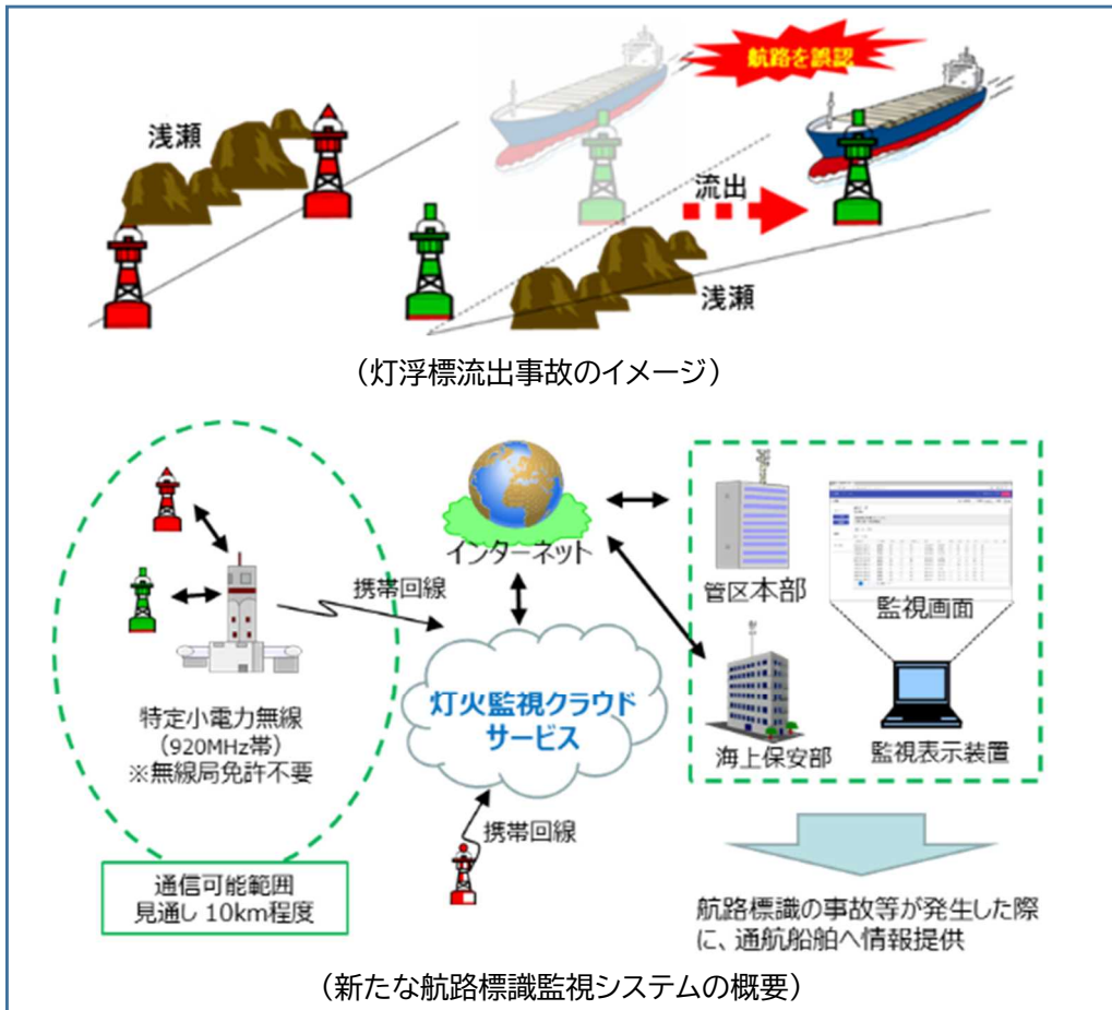
【(図表⑳)クラウドサービスを活用した新たな航路標識監視システム】〔出典：海上保安庁〕
