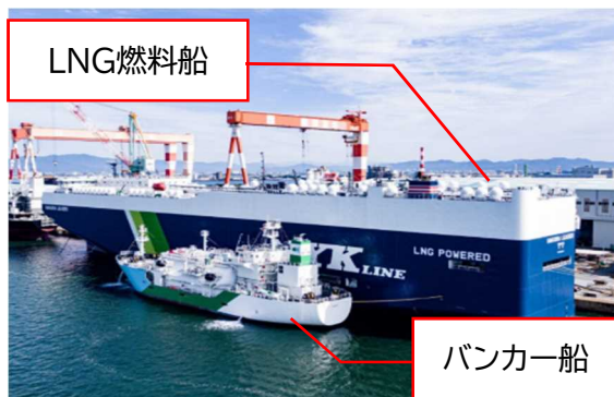
10 【(図表㉗)バンカー船によるLNGの燃料供給の 11 様子】[提供:セントラルLNGマリンフューエル]
