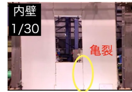
木造軸組耐力壁の加力実験
