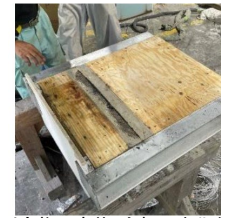
水切り金物の変状・合板の炭化なし
