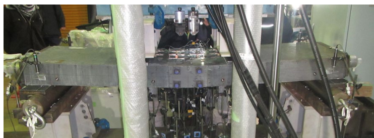
写真-2 接合部を含む繊維補強コンクリート床版の曲げ試験
