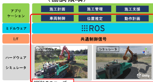
図-2 自律施工技術基盤 OPERA
