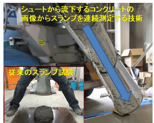
写真-3 画像解析によるスランプの連続測定技術のイメージ
