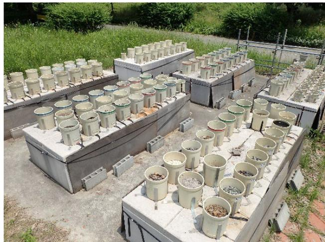
マニュアル（2023年版） 実態に即した溶出現象評価実験の継続的な実施例（土研式雨水曝露試験）
