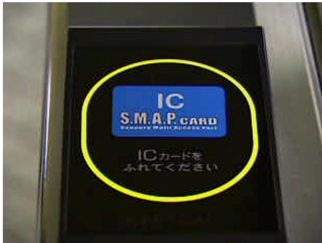
図 -3 交通系 IC カード対応改札機 R/W 部分
