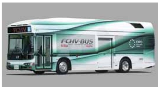
図 3-19 愛知万博に導入された日野・トヨタ製水素燃料電池バス(出典: JHFC、2005 年)
