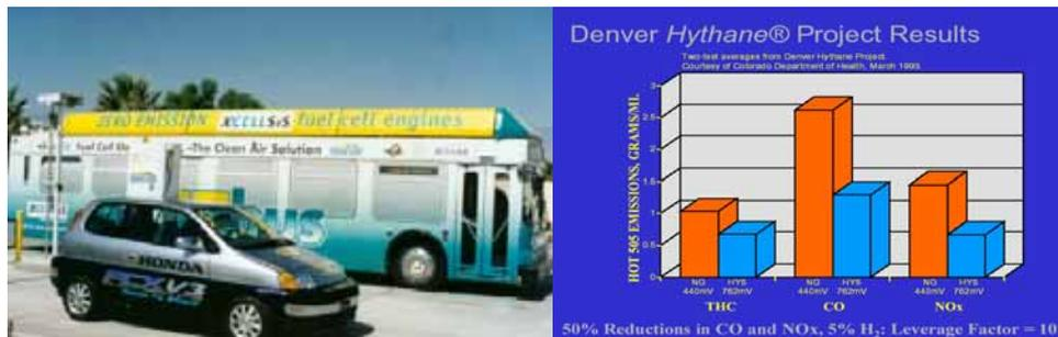
図 4-7 フランスで実証中のハイタン・バスと乗用車(左)、米国での温室効果ガスの著しい削減効果データ(右)
