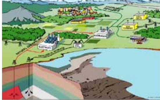
図 4-6 CO<sub>2</sub>の回収～地中隔離を伴う化石燃料ベースの水素エネルギー社会への移行段階イメージ図(出典: Statoil, 2003年)
