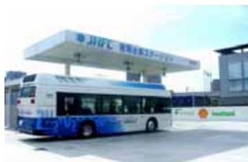
図 4-16 東京有明水素ステーションと日野・トヨタ製燃料電池バス(出典:Shell,2004年)
