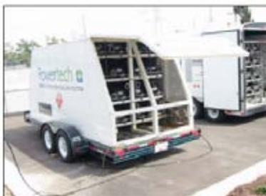
図 3-14 Powertech の可動式水素供給ステーション
