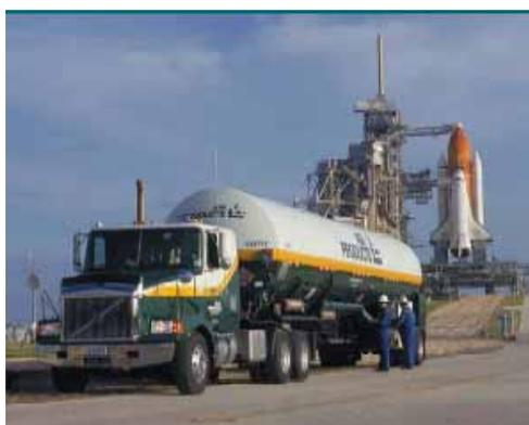
図 4-10 NASA 向けの液体水素のタンク・ローリー輸送(出典: Air Products, 2004 年)
