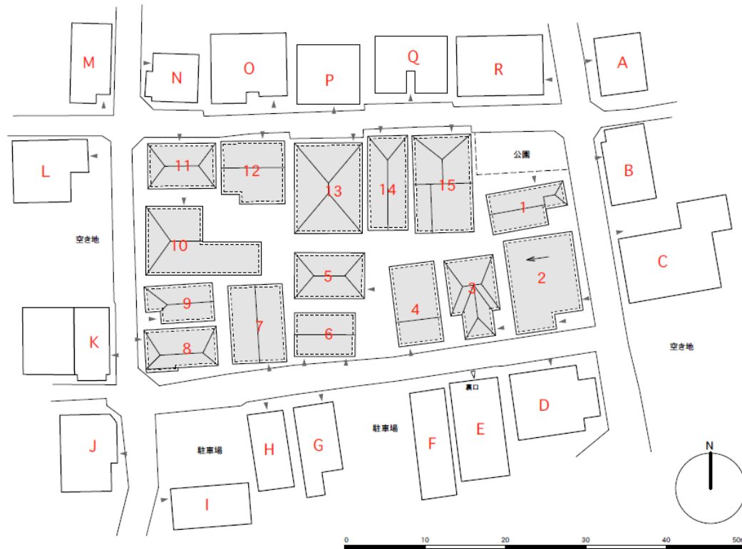
図 4-9 対象街区及びその周辺の建築物の配置状況、屋根形状
