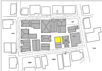
③2軒(南側中央):北側の1階2階部分を減築
