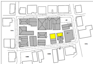
⑤南側全て:北側の1階2階部分を減築
