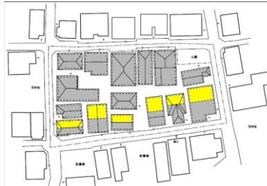
④南側全て:北側の1階2階部分を減築
