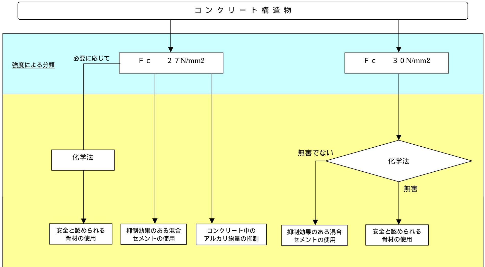
高強度コンクリートを使用する場合は化学法で無害と判定された骨材を使用する
