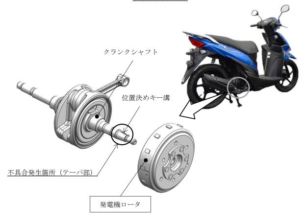
クランクシャフトの発電機ロータ取付部のテーパ加工が不適切なため、当該クランクシャフトと発電機ロータが正しく嵌合していないものがある。そのため、エンジン回転時にクランクシャフトの発電機ロータ位置決めキー溝に過大な荷重がかかり、最悪の場合、クランクシャフトが破損し、走行中にエンストに至るおそれがある。
