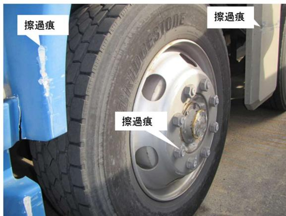
写真2 車体左前フェンダー、ホイールボルトの擦過痕
