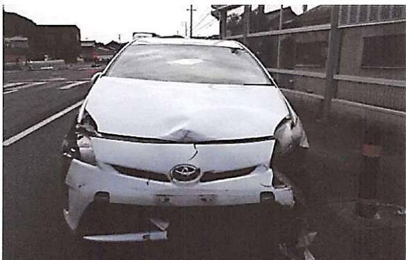
写真5 前部の破損状況
