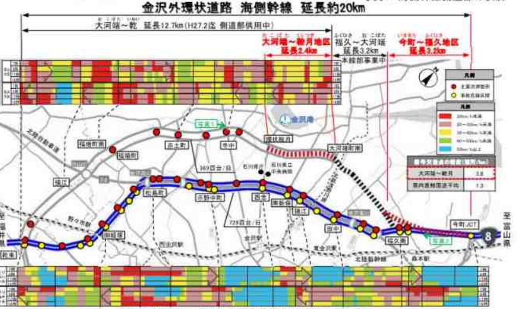
図2 国道8号及び金沢外環状道路海側幹線の交通状況
