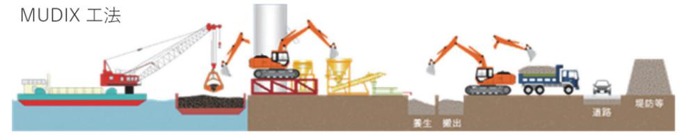
掘削 → 土運船 → 揚土 → 固化処理 → 養生 → 搬出運搬 → 再利用
