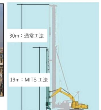
MITS 工法機械概要図
