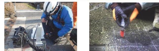
分野 床版コンクリート内部ひび割れ調査 区分 工法
