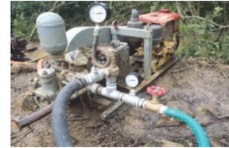
高品質コアを採取する上で最も重要なのは削孔水のコントロールです。弊社で独自に開発したバルブにより吐出ラインから0.5Mpmの圧力で適量の水が自動的にコアチューブに送り続けられる。自動化された削孔水のコントロールにより、例えば孔が閉塞しようとしたときにも対応するため、経験の浅いオペレータでも高品質コアの採取が可能となる。これにより、現地人ワーカーの早期戦力化が可能となる。
