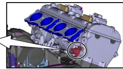
カムシャフトチェーンの張力を調整するテンショナにおいて、使用により内部の部品が劣化しプランジャが押し戻され、プランジャがロックすることがある。プランジャがロックされた状態で使用を続けると、カムシャフトチェーンに張力が掛からずに異音が発生し、最悪の場合、カムシャフトタイミングがずれ、走行中にエンジンが停止することがある。
