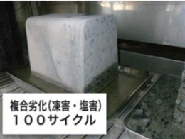
ハレーサルト 普通コンクリート 複合劣化(塩害・凍害)抵抗性の比較
