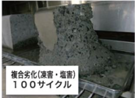
ハレーサルト 普通コンクリート 複合劣化(塩害・凍害)抵抗性の比較
