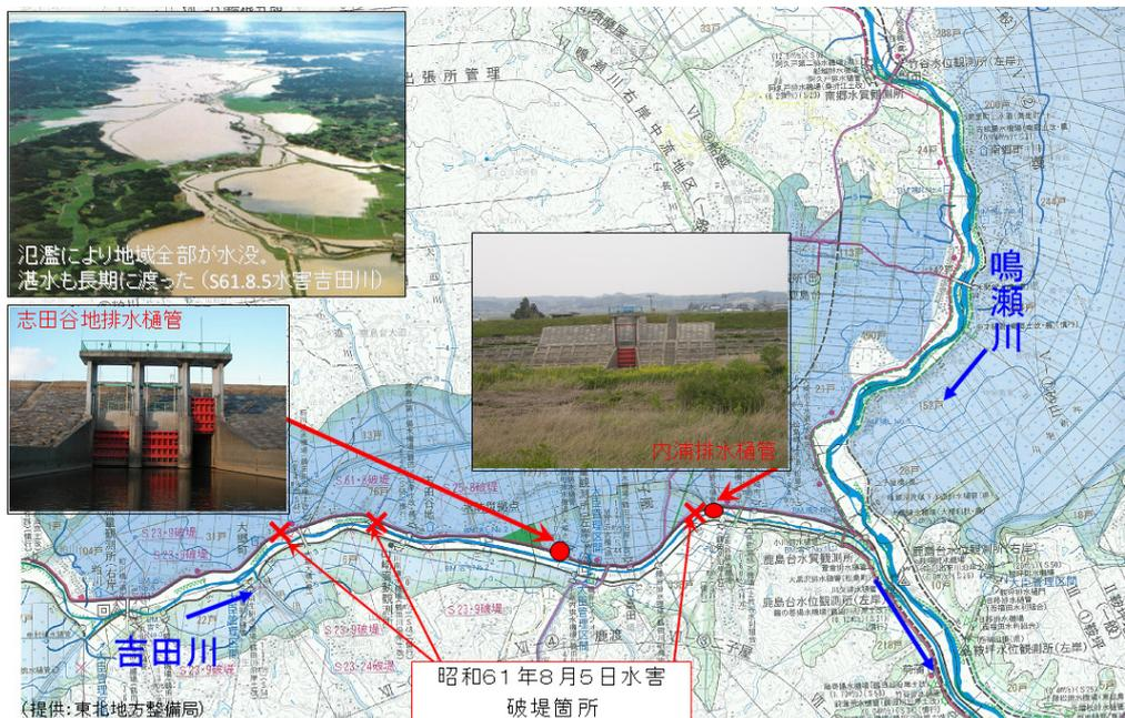
図3-14 氾濫水の排水対策(鳴瀬川水系吉田川の事例)
