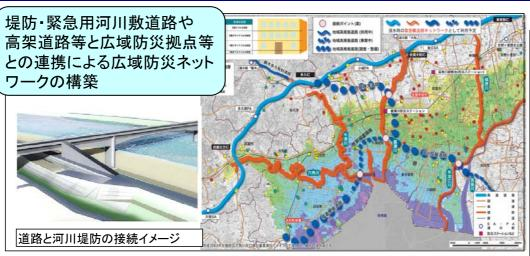
堤防上の管理用道路が橋梁により分断されていたり、舗 装が重車両の走行に対応していないことから、タンクロ-リー車が緊急時に走行できないおそれがある
