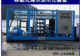
渇水時における水不足を補うために、海水淡水化装置を搬送可能な構造にしたもの
