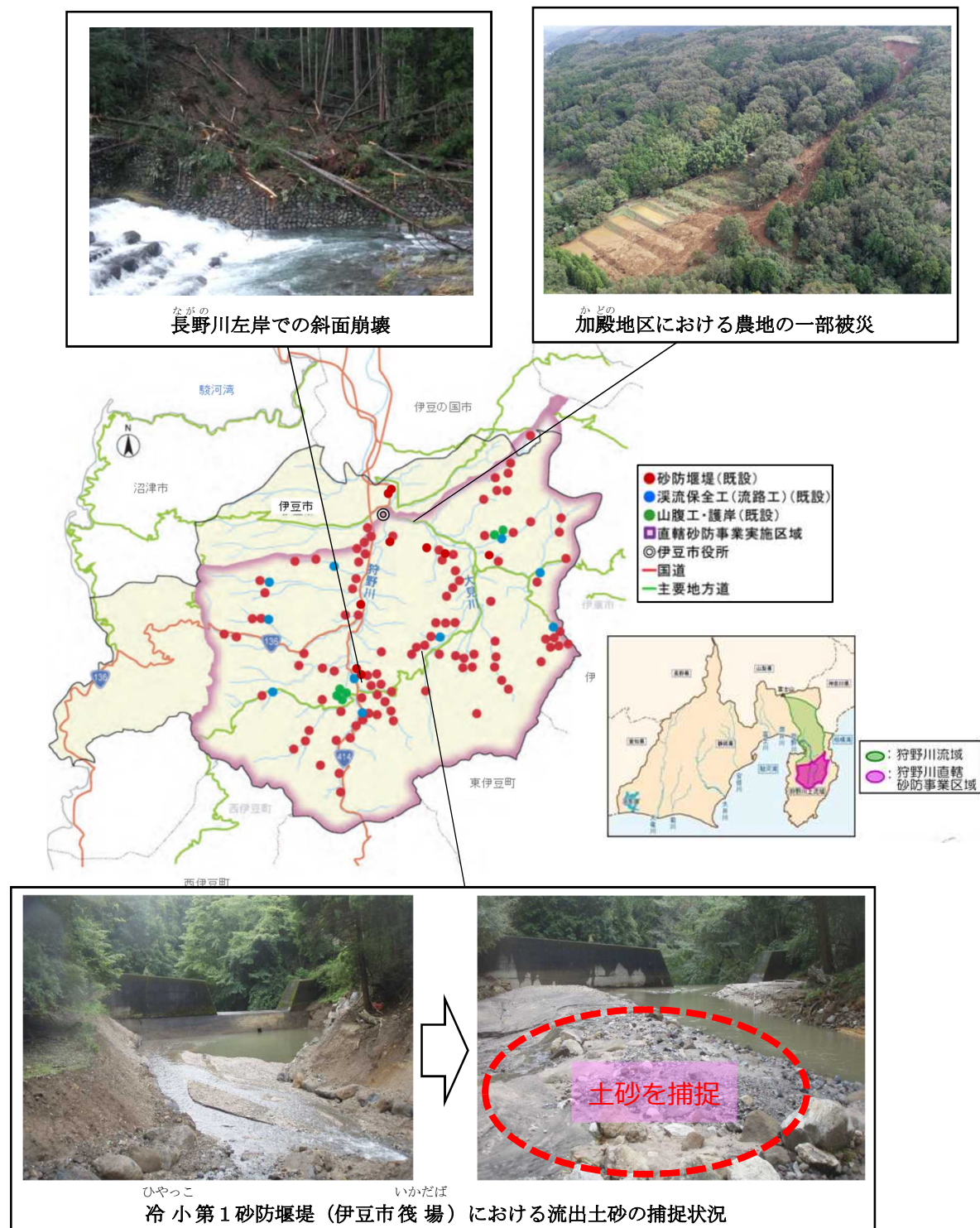
図 2-7 令和元年東日本台風に伴う被災状況及び流出土砂の捕捉状況
