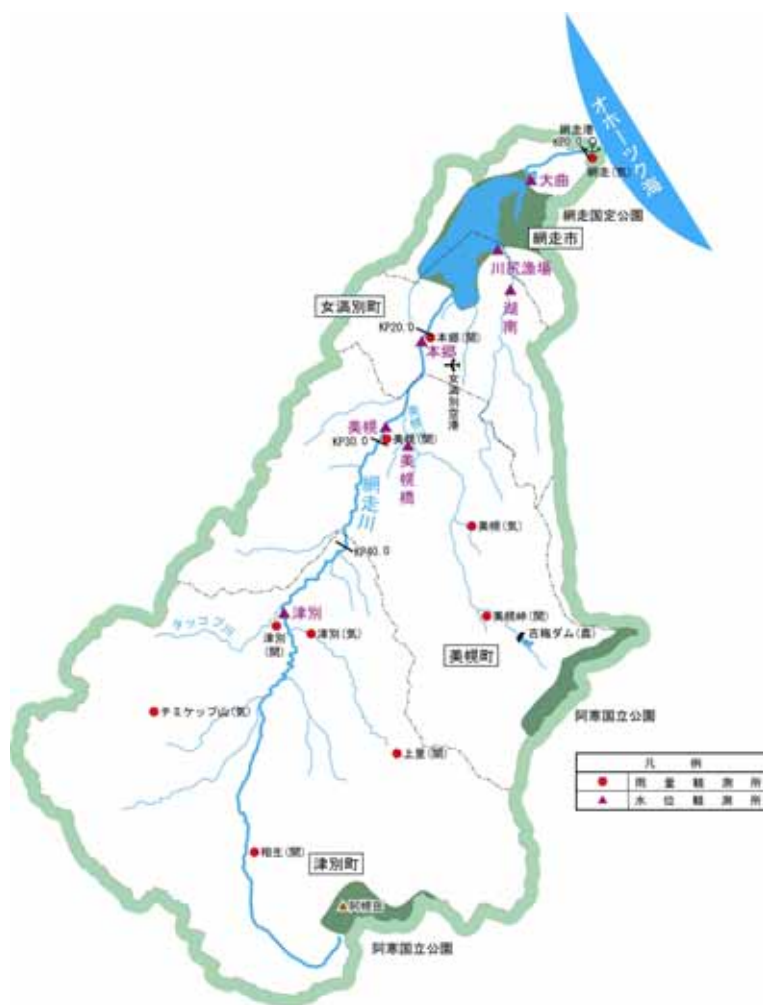
図 9-1 洪水予測区間及び雨量・水位観測所
