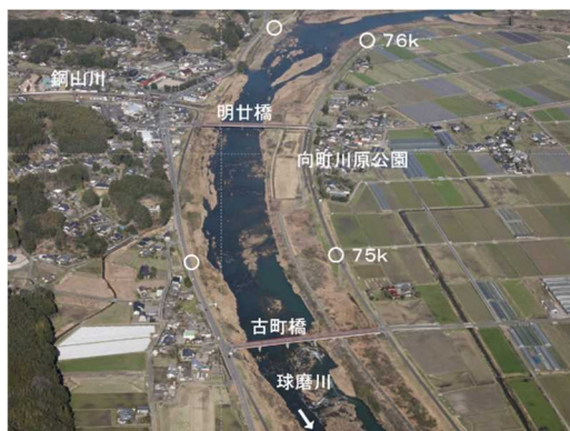
砂利採取や河川改修による岩盤の露出 (75k400 付近)
