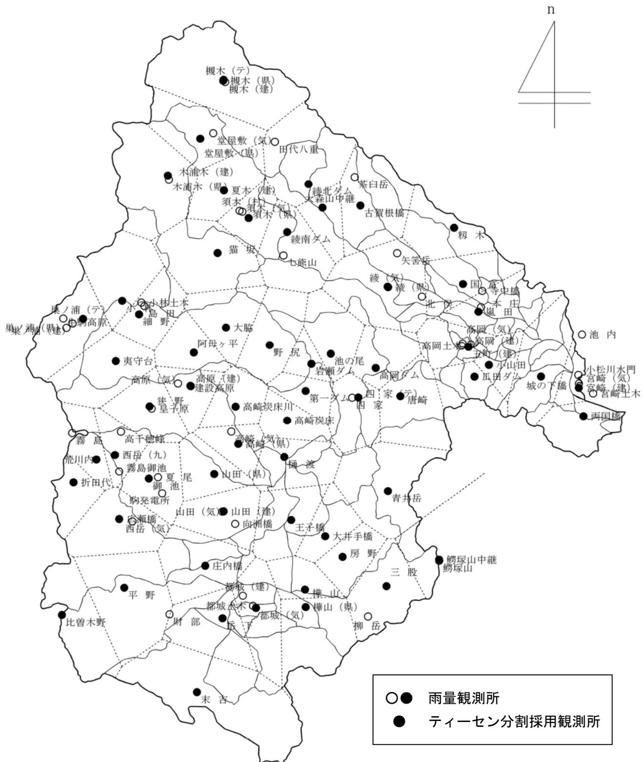
図 4.2.2 (3) 時間雨量ティーセン分割図 (平成 23 年 9 月洪水)
