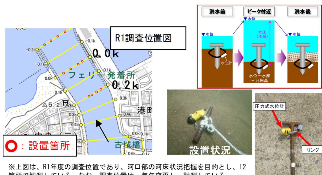
図4-1 洪水時河床モニタリング（リングセンサー設置）
