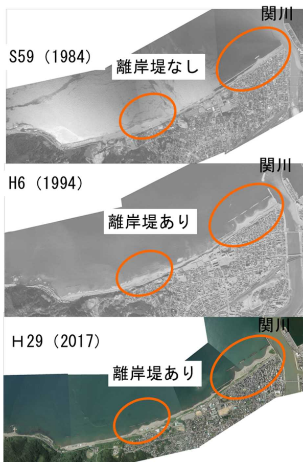
図3-4 関川河口部西側の離岸堤による汀線の変化
