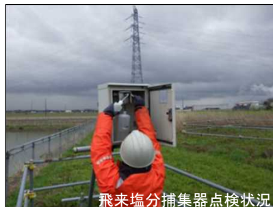
飛来塩分捕集器点検状況
