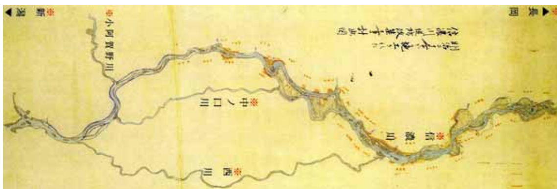
図 4-43 信濃川築堤工事計画図
