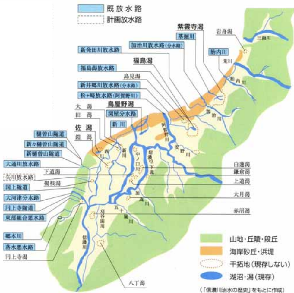
越後平野の放水路の整備状況
