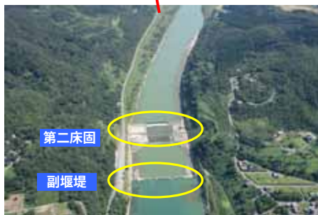
写真 4-62 大河津分水路垂直写真と床留群
