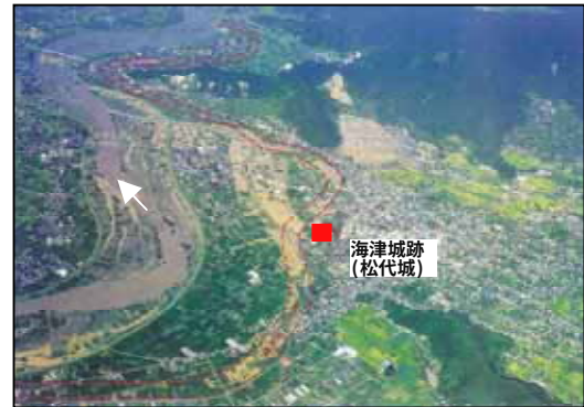
写真 4-50 瀬直しによる河道の変化
