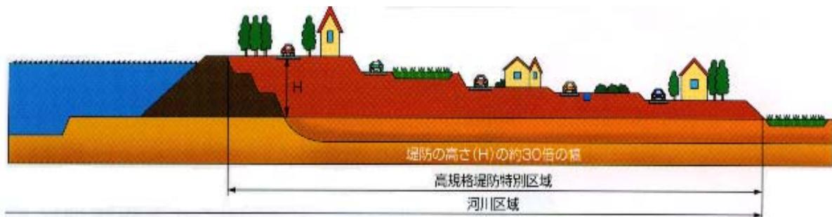
スーパー堤防は、堤防の幅が高さの30倍程度あり、「浸透」「越水」「地震」に強い構造である。また、川裏側（堤内地）は緩やかな傾斜であることから、川へのアクセスや眺望の良い街を造ることもでき、安全で川に親しむ空間の創出も図られる。
