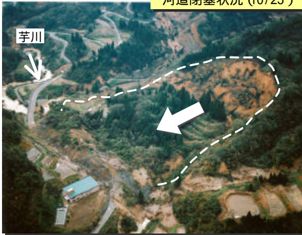
【地すべり土塊により閉塞した芋川 (地震発生2日後の状況)】
