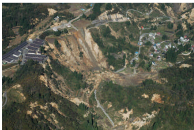
【大規模な地すべりにより発生した 土砂災害(新潟県山古志村)】
