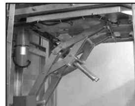
換気口浸水防止機
