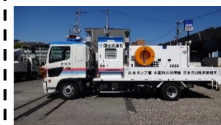
排水ポンプ車
