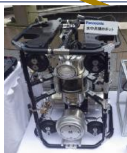
水中構造物調査用ROV
