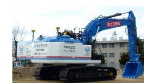
分解組立型（遠隔操作式）バックホウ
