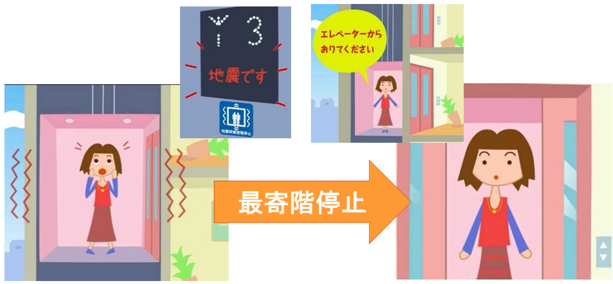
地震時管制運転装置の仕組み
