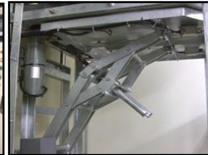
換気口浸水防止機
