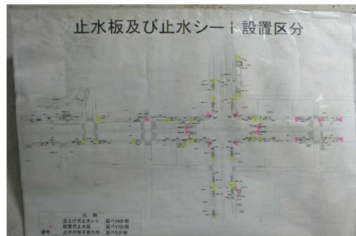
地上の出入口（流入入口）浸水防止用設備設置箇所図
