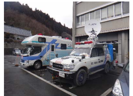
衛星通信車による途絶した通信回線の確保
