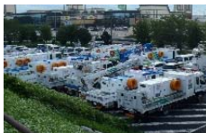
排水ポンプ車
