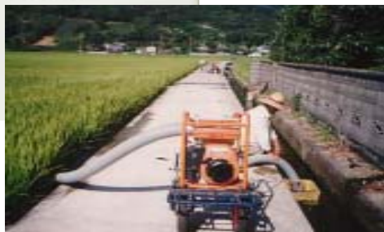
応急ポンプかんがい
