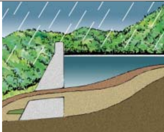
排砂ゲート(土砂フラッシュ)
