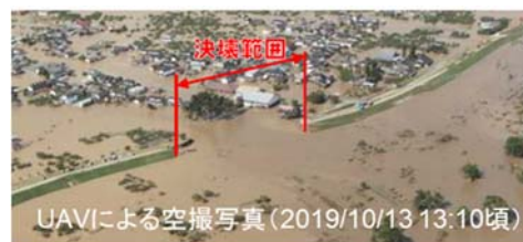
図-2 越水による決壊(千曲川)
