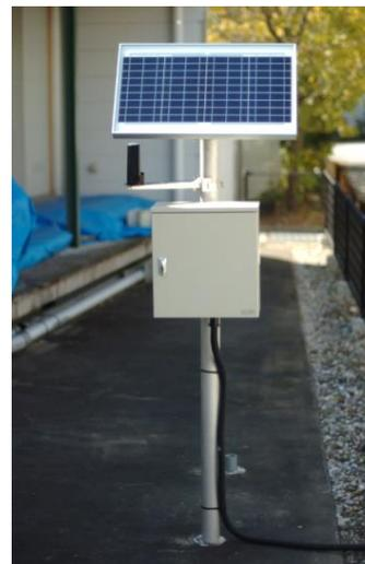
←水位計+通信機+ソーラー設置例
