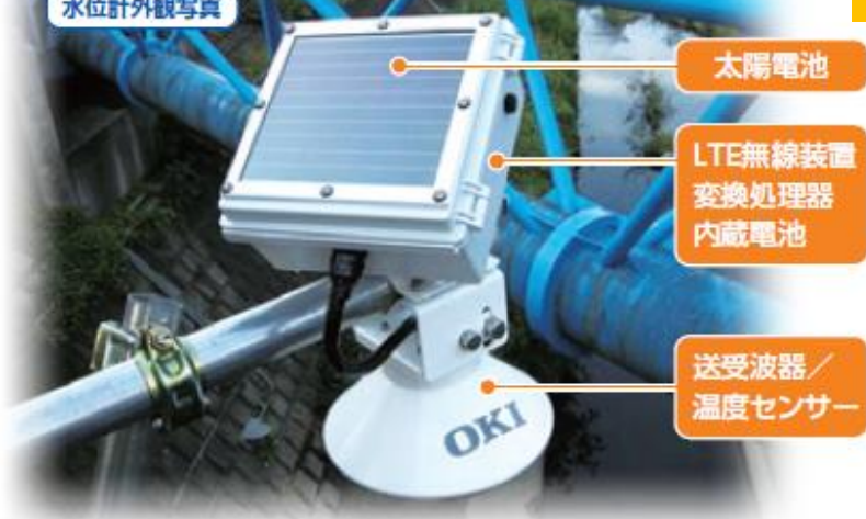
水位計外観写真
