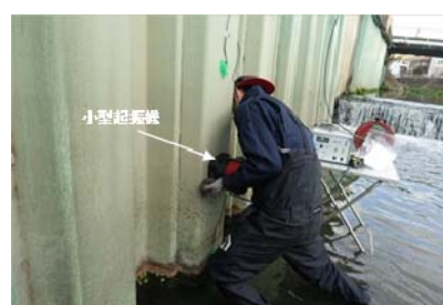
図16 小型起振機による局部的な強制加振
