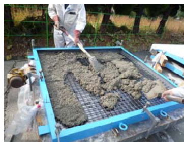
図-3 実寸大試験扉体の製作（外枠+内筋+モルタルの複合構造）
