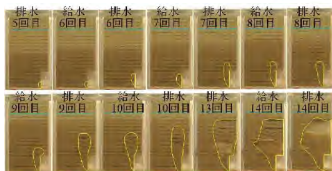
図-5 二次元模型実験による空洞・ゆるみ領域発達の観察
