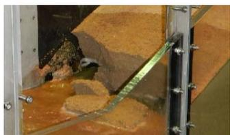
図-4 B.の進行性破壊の状況
