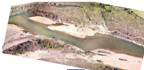
第4中聖牛群設置後 2022年2月の河床地形
