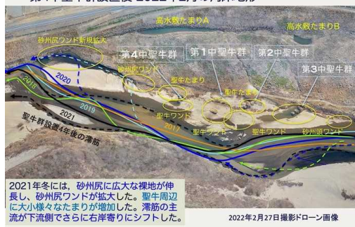
図-6 中聖牛群設置前後における河床地形の変化
