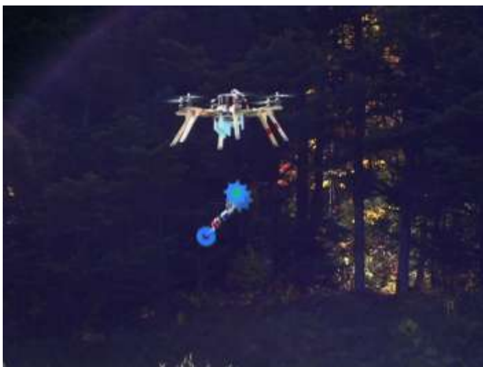
図 22 TOBI による GeoStar-Mini 投下試験
