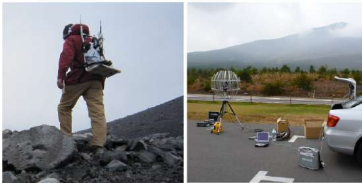
図 11 通信試験の様子:通信機を担いで登山道を移動する様子(左)と駐車場に設置した地上局(右)
