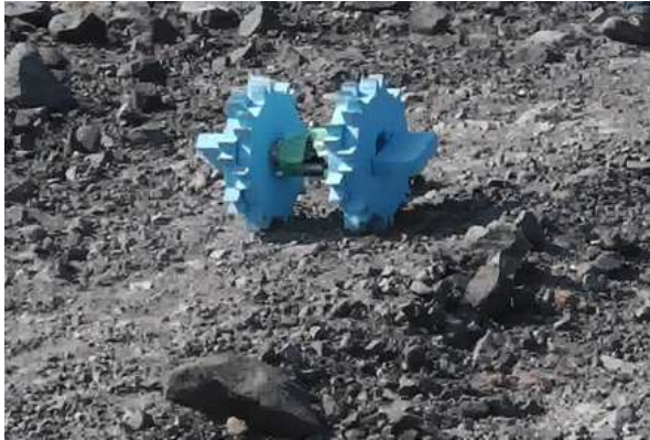
図 12 超軽量移動ロボット GeoStar
