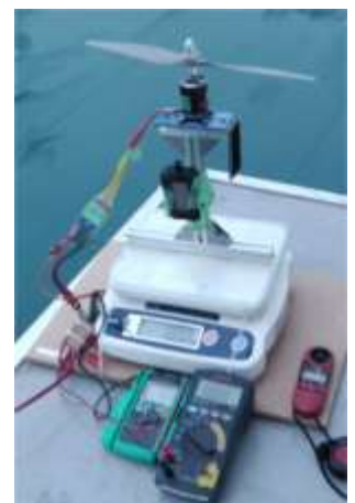
図 15 翼の推力試験器
