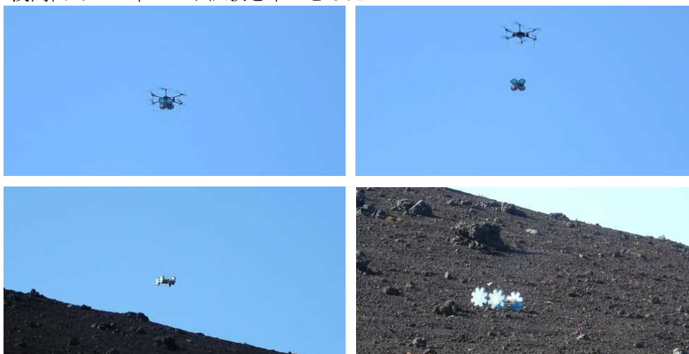
図4：三原山での移動ロボット降下試験
